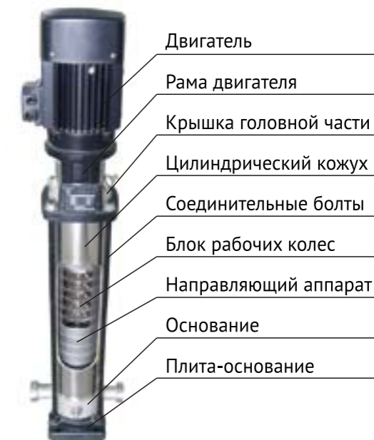
Рис.2. Конструкция насосов
